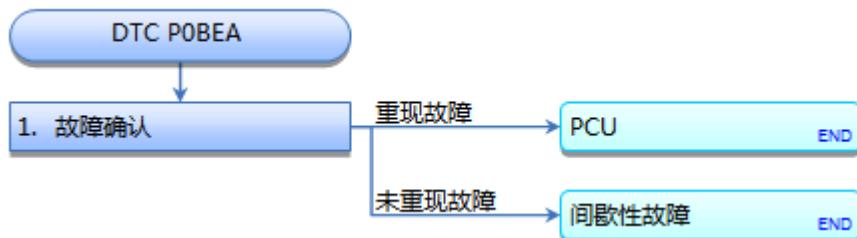
**DTC P0BEA:** 牵引电机 V 相电机电流传感器范围/性能故障
